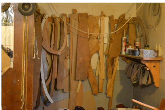
Slika 14: Pri risanju delov na les si kolar pomaga s šablonami. Šablone v Pergarjevi delavnici.
