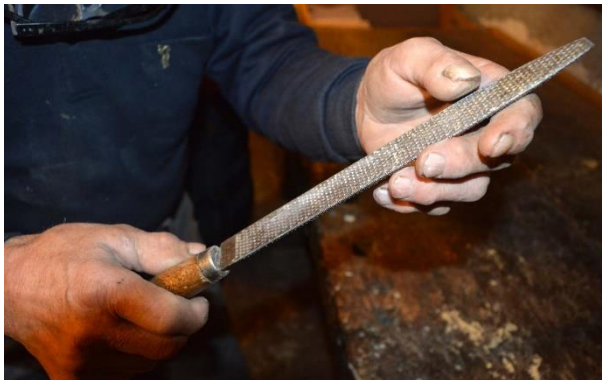
Slika 26: Rašpa z drobnimi zobci po površini za obdelovanje nekovinskih predmetov.
