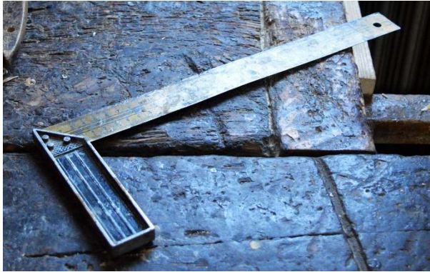
Slika 24: Kotomer (»vinkel«) je stalni kolarjev pripomoček.
