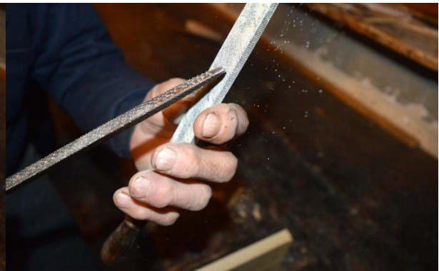
Slika 27: Pila z vzporednimi grebeni po površini za obdelovanje kovinskih predmetov.
