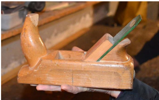
Slika 30: Oblič, orodje za glajenje lesa.
