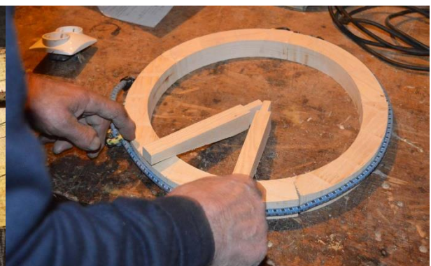
Slika 33: Pripravljanje špic. Dele platišča je kolar povezal z močno gumico.
