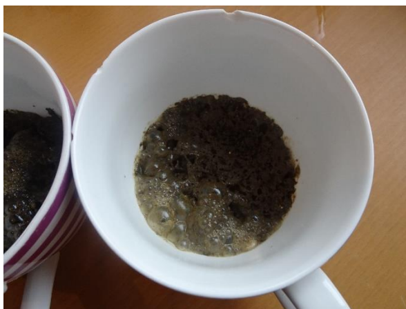
Slika 28: Reakcija ob dodajanju klorovodikove kisline v lonček z vzorcem prsti (foto: Brina Umek).
