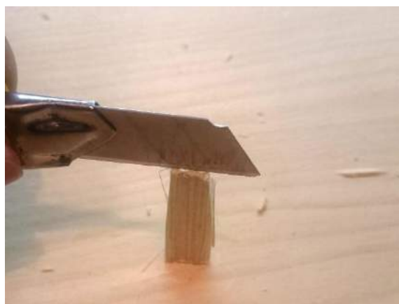
Slika 138: Te dele nato cepimo na več manjših debelih skodel. Da jih stanjšamo, olfa nož postavimo tja, kjer bomo skodlo razklali.
