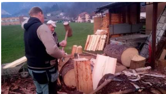
Sliki 51 in 52: S kladivom udarjamo po sekirah, da se les razcepi. Iz debla nacepimo 8 do 10 špevt.
