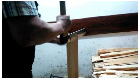
Slika 76: Skodlo stanjša s šinklarico tako, da je po vsej dolžini približno enako debela.
