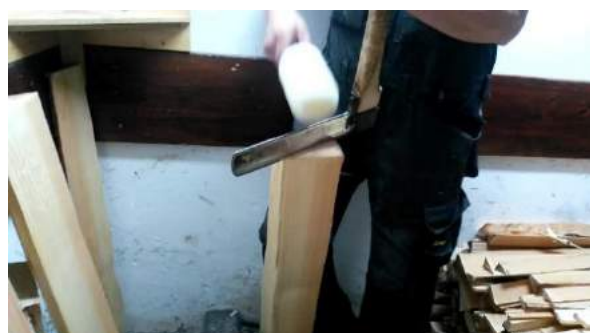
Slika 64: Z batom udarjamo po šinklarici.
