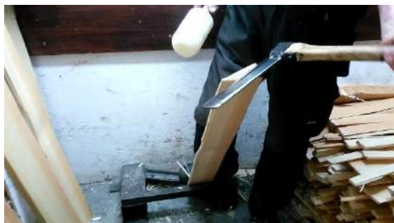
Slika 67: Šinklarico položimo že na prej označeno debelino.
