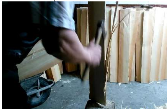
Sliki 77 in 78: Skodlo s sekiro zoža, da je v vsej dolžini enakomerno široka.
