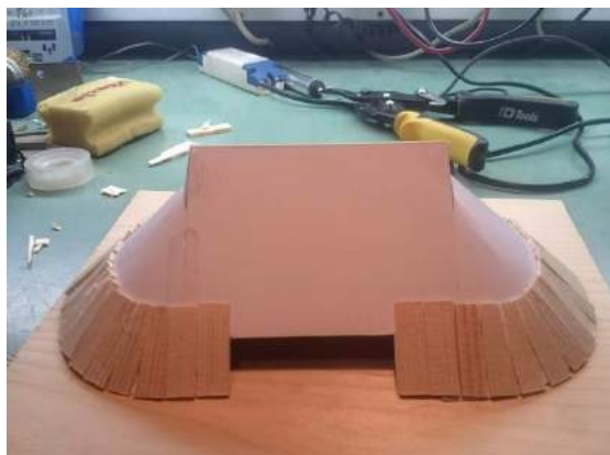
Slika 141: Streho smo začeli (s pištolico za vroče lepljenje) lepiti spodaj. Na okrogolino smo nalepili skodle, ki so bile odrezane v konus.
