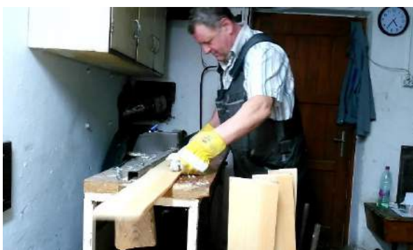
Slika 86: Skodlar Franc Potočnik ravna stranske robove skodel.
