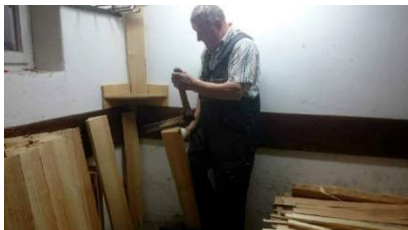
Slika 58: S šinklarico na špevti označimo debelino skodel (po približno 10 mm).
