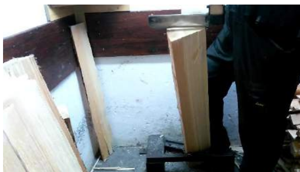
Sliki 59 in 60: Špevti odstranimo trikotni del.
