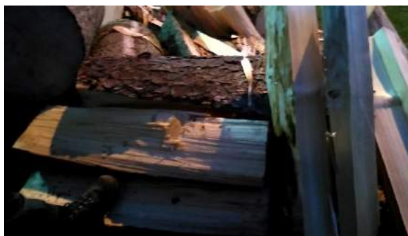
Sliki 39 in 40: Desnosučen les ni uporaben za skodle.
