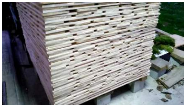
Slika 89: Skodlar zloži izdelane skodle na križ v dva metra visoko skladovnico.
