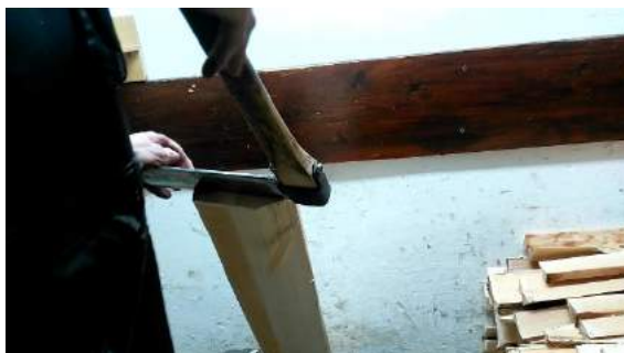
Slika 68: Z batom udarimo po šinklarici, da se zareže do dna špevte.
