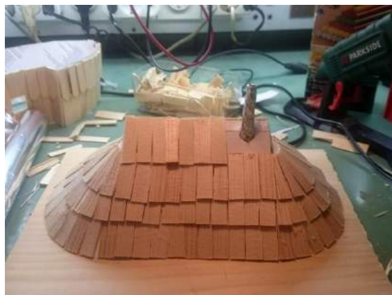
Slika 142: Polaganje skodel nadaljujemo do vrha strehe. Dodamo še dimnik iz aluminijaste folije.
