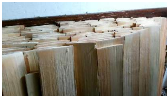
Sliki 87 in 88: Dokončno izdelane skodle zloga ob steno delavnice.
