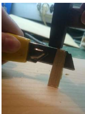
Slika 139: S kladivom potolčemo po olfa nožu, da zareže v les. Tako dobimo dve tanjši skodli.
