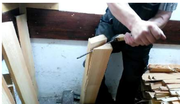
Sliki 59 in 60: Špevti odstranimo trikotni del.
