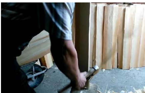
Sliki 83 in 84: Zaradi uravnavanja širine in debeline skodle, gre del teh v odpadek.
