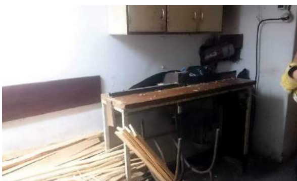
Slika 85: V kotu delavnice stoji rezkalni stroj, ki služi za poravnavo roba skodel.
