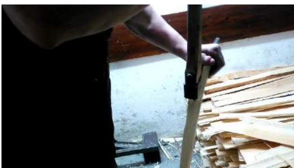
Slika 70: Izdelamo še zadnji dve skodli.
