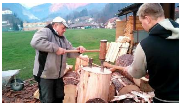
Sliki 45 in 46: Špevto naredimo tako, da s sekirama označimo njeno širino, nato pa s kladivom udarjamo po njih, da razkoljejo les. Skodlarju pomaga sin Matej.
