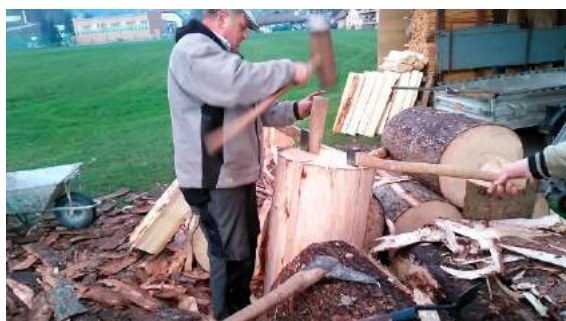
Slika 47: V režo vstavimo zatič in udarjamo po njem.
