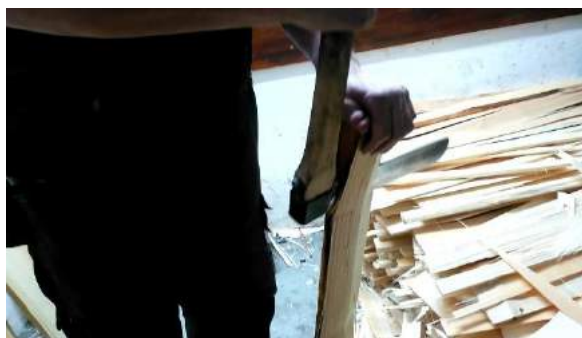
Slika 71: Pri cepljenju si skodlar pomaga z roko.
