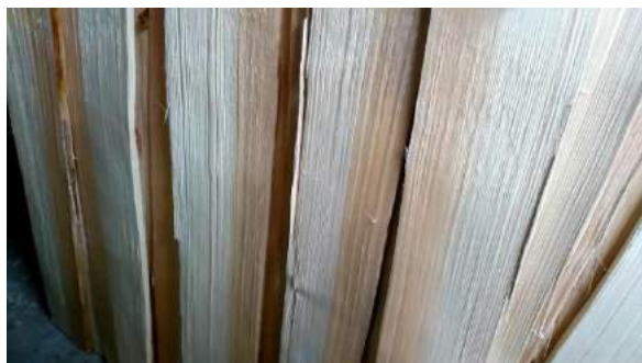
Sliki 87 in 88: Dokončno izdelane skodle zloga ob steno delavnice.
