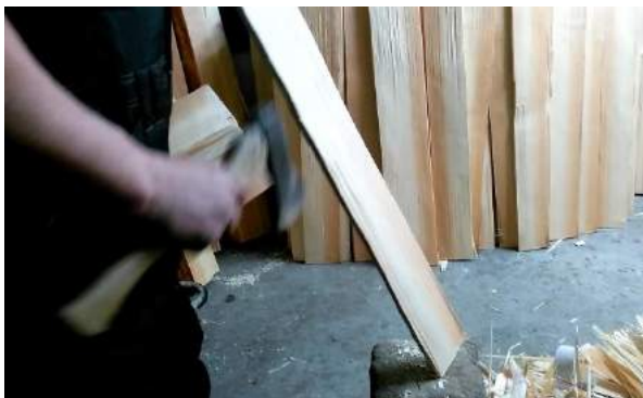
Slika 81 in 82: Skodle oža s šinklarico in sekiro.
