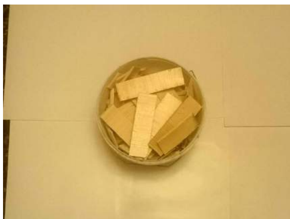
Slika 137: Les za skodle, ki smo ga prej osušili, narežemo na 4 cm široke dele.
