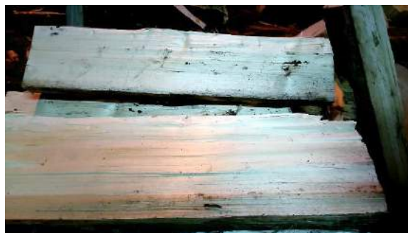
Slika 42: Če ima cepljen les prevelike žlebove, prav tako ni uporaben za izdelavo skodel.
