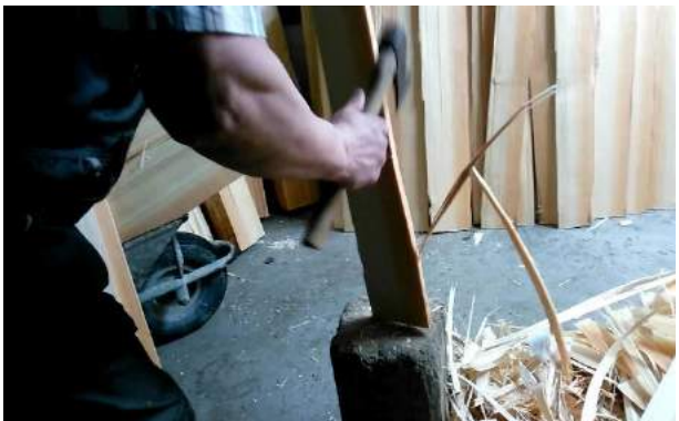
Sliki 77 in 78: Skodlo s sekiro zoža, da je v vsej dolžini enakomerno široka.
