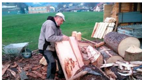
Sliki 45 in 46: Špevto naredimo tako, da s sekirama označimo njeno širino, nato pa s kladivom udarjamo po njih, da razkoljejo les. Skodlarju pomaga sin Matej.
