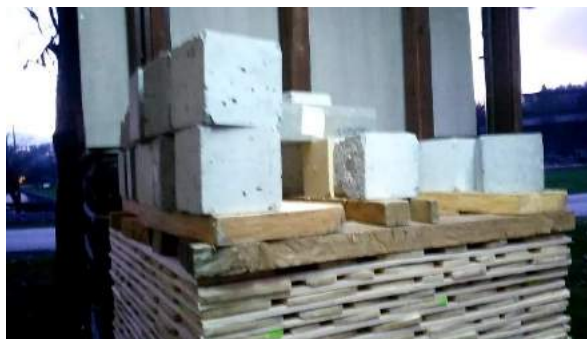
Slika 90: Skladovnico obteži z betonskimi bloki. Po potrebi uteži premika z ene strani na drugo.
