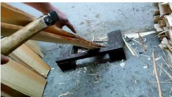
Slika 72: Pri cepljenju skodel špevte zataknamo v kovinsko držalo.
