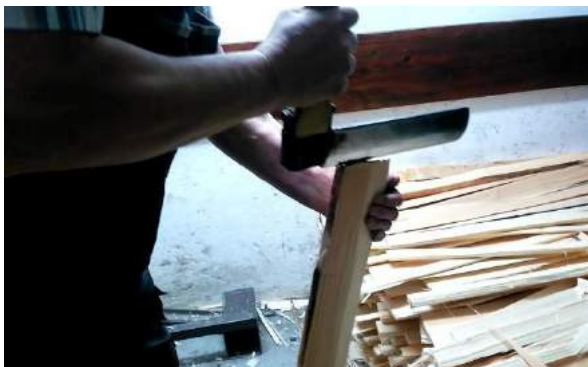
Slika 81 in 82: Skodle oža s šinklarico in sekiro.
