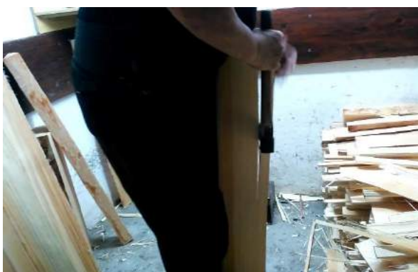
Sliki 83 in 84: Zaradi uravnavanja širine in debeline skodle, gre del teh v odpadek.
