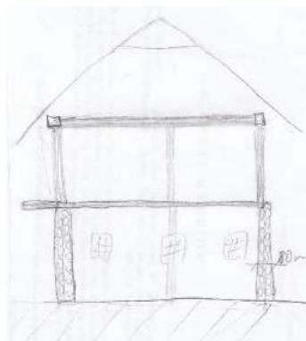
Skici 8 in 9: Skiciranje izdelave betonske plošče za strop v dnevni sobi, ki je obsegala tudi širino ganka.
