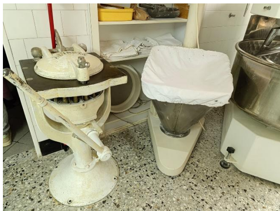
Sliki 27 in 28: Preša za razrez testa za žemlje (levo) in današnji stroj za mesenje (desno).
