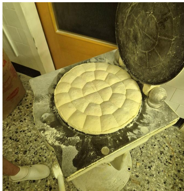
Slika 9: V preši so noži, ki testo razrežejo v enakomerne dele za žemlje.
