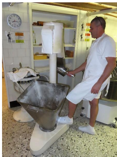
Slika 58: Pek Pavel razkazuje delovanje stroja za sejanje moke, 21. 1. 2025 (foto: S. Merčun).
